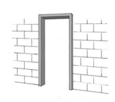
Fig. 7: Colocación de precercos
